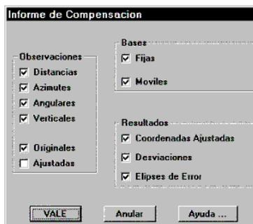
Para obtener los datos de las observaciones, podemos seleccionar entre las de **Distancia**, **Acimutes**, **Angulares** y **Verticales**, pudiendo ser además las **Originales**, las **Ajustadas** o ambas. Podemos incluir o no la información de las **Bases Fijas** y **Móviles**, así como los resultados de **Coordenadas**
