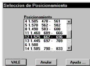
En este método las combinaciones se calculan de tres en tres, eliminándose automáticamente las mal condicionadas en las que se da el caso denominado "Círculo Peligroso".
